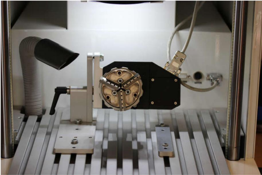
Mit selbstzentrierendem Präzisions-Schnellspanbackenfutter
